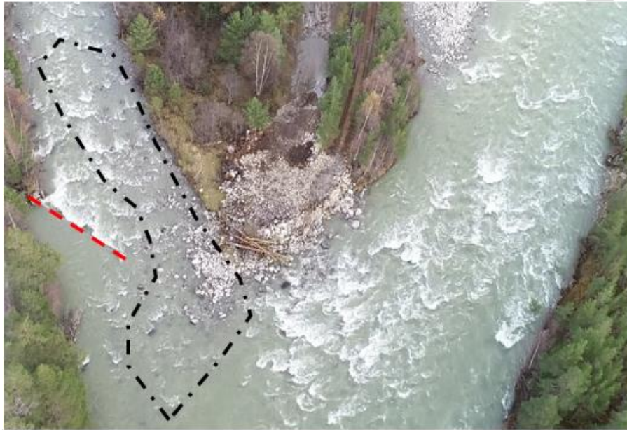
Erosjonsskade – spissen av Åmotsøyi. Stiplet linje viser ca. området for uttak av masser. Rød stiplet linje markerer terskel som ikke skal røres.
